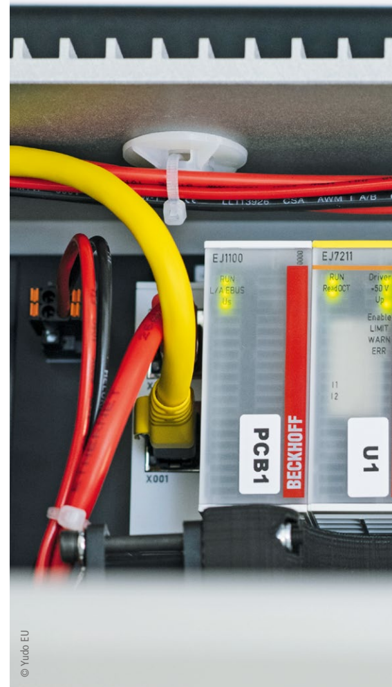
Mit den EtherCAT-Steckmodulen der EJ-Serie kann die I/O-Ebene äußerst kompakt gestaltet werden.
